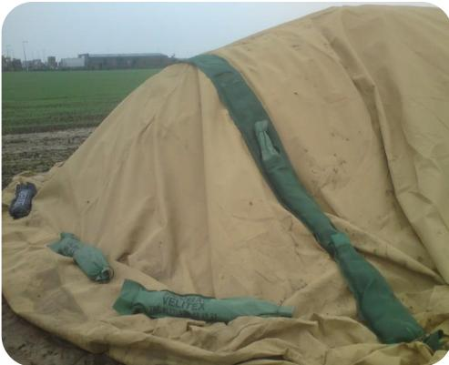
Subtex® 200, c'est la solution pour protéger vos composts de la lixiviation. De part sa fabrication, la bâche est très souple, il faut donc la tendre le plus possible afin que l'eau ruisselle dessus, les nutriments, eux, restent dans le tas.
