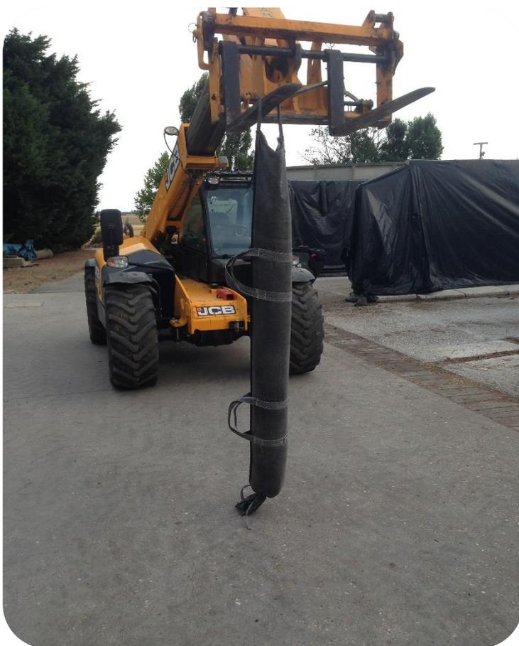
Le Slopebag se pose facilement sur votre silo grâce aux fourches de votre télescopique ou tracteur-fourche. Rapide, efficace, de part son poids et sa stabilité dimensionnelle il permet de réaliser le silo parfait.
